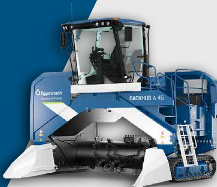
La BACKHUS A 45 marca el comienzo del rango medio, aunque destaca como una máquina poderosa en el mercado: con un ancho de hasta 4,5 m y una altura de volteo máxima de 2,3 m, consigue un rendimiento de hasta 3.000m<sup>3</sup> por hora, dependiendo del material.
